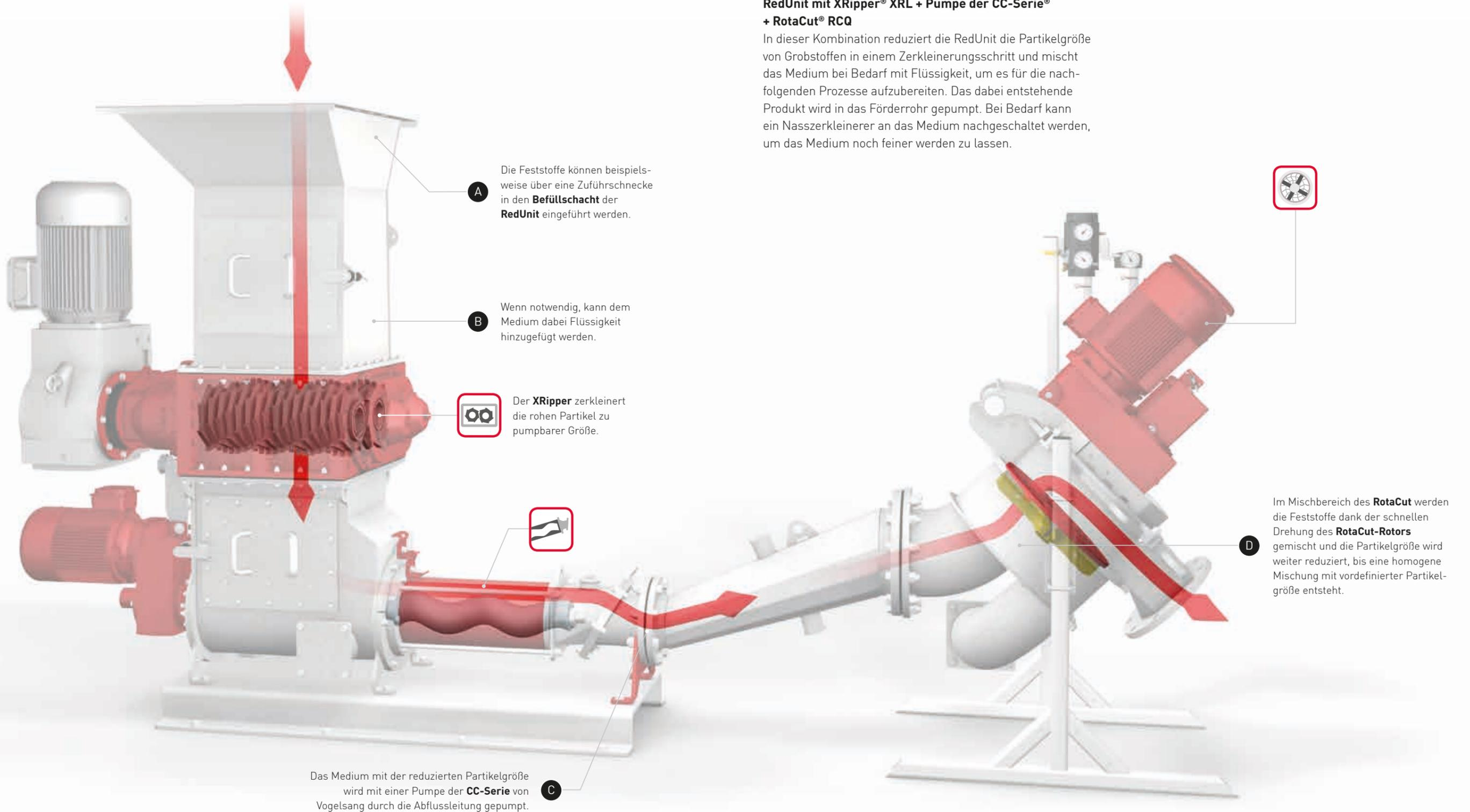
**A** Der **XRipper** zerkleinert die rohen Partikel zu pumpbarer Größe.
