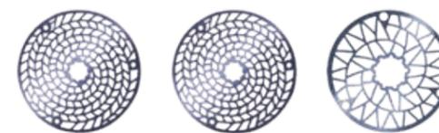
Vogelsang nutzt eine eigene Software zur Berechnung der optimalen Schneidsiebgeometrie für den gewünschten Zerkleinerungsgrad. Das bedeutet für unsere Kunden, dass sie immer die beste Schneidsiebgeometrie für einen optimalen Betrieb bei minimalem Verschleiß bekommen. Die Schneidsiebe bestehen aus hochverschleißfestem Spezialstahl und sind umkehrbar.
