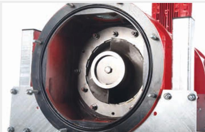
Lo sportello di manutenzione, facilmente raggiungibile, fornisce l'accesso rapido alle vite di pressatura e al setaccio in qualsiasi momento.
