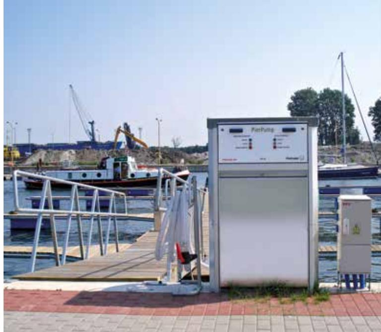
**La tecnologia deve essere facile da usare e sempre accessibile. Il cuore dei nostri sistemi di smaltimento è l'originale pompa a lobi rotativi Vogelsang: una pompa volumetrica autoadescante appositamente progettata per fluidi viscosi e liquidi contaminati da corpi estranei. Il fluido viene aspirato direttamente dai robusti lobi rotativi rivestiti in elastomero e pompato nella rete fognaria.**
