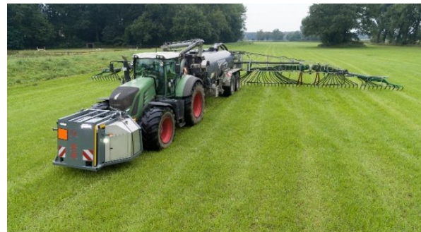
Immagine 4: Acidificazione del liquame durante l'applicazione sul campo con SyreN (qui in combinazione con un sistema a barre sospese SwingMax).
