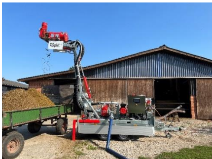
Immagine 3: Separatore a coclea XSplit come soluzione di sistema con pompa e tecnologia di controllo.
