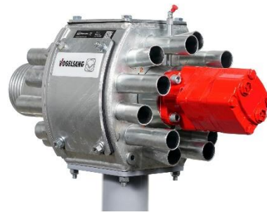
Immagine 2: Il distributore ad alta precisione ExaCut ECM senza aspirazione è particolarmente adatto per le applicazioni in cui non vi è molto spazio sul lato barra per il distributore.
