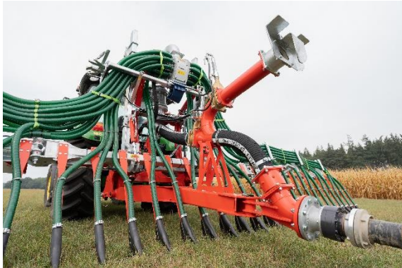
Immagine 1: La barra universale UniSpread (qui con sistema di spandimento a pattino) nella variante per sistema ombelicale.
