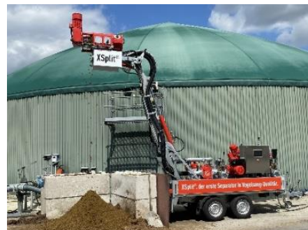
Immagine 4: Separatore a coclea XSplit: separazione innovativa come soluzione di sistema (come in foto) o come singola unità.
