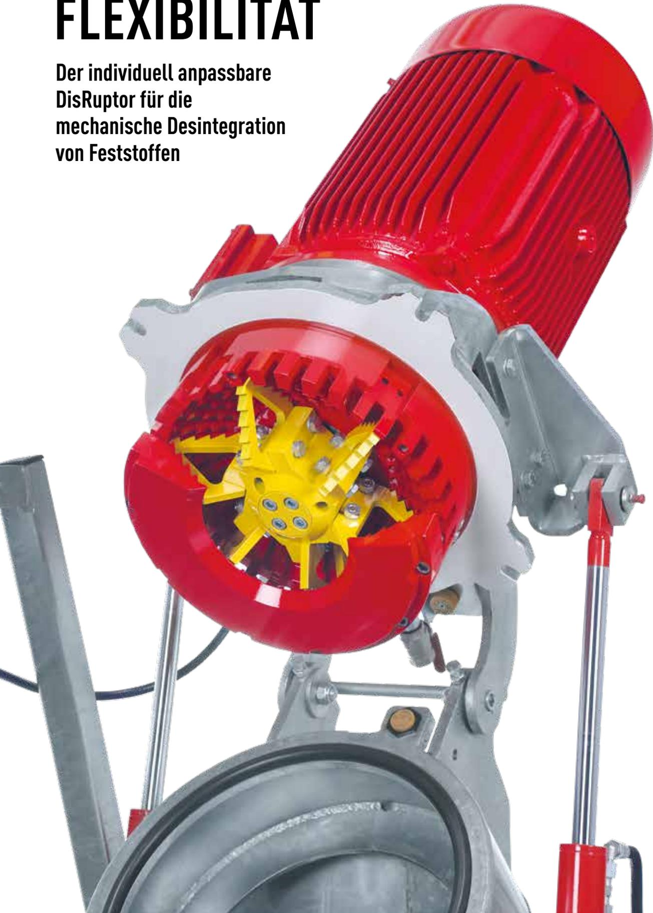
Eine optimale Substrataufbereitung trägt entscheidend zur Biogasausbeute bei. Weshalb Vogelsang mit dem flexibel konzipierten DisRuptor auch eine mechanische Alternative für die Desintegration von Substraten bereithält. Durch die Reduzierung der Partikelgröße und das gleichzeitige Zerfasern wird die Oberfläche der eingesetzten Feststoffe vergrößert. Auf diese Weise gelangen die Bakterien leichter an die Nährstoffe, die Umsetzung wird beschleunigt und der Gasertrag gesteigert.
