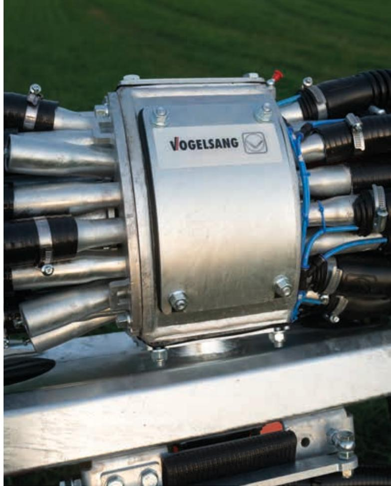
Comme son grand frère, l'ECC ExaCut, l'ECM ne nécessite pas d'admission d'air. Cependant, il n'y a jamais eu de distributeur aussi compact que l'ExaCut ECM. Cela permet un principe de coupe similaire à celui du RotaCut. Un rotor qui ne ferme jamais complètement les trous de la grille de de l'écran de coupe permet un écoulement régulier et sans pulsation du média.
