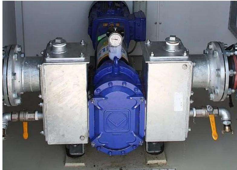
Die Drehkolbenpumpe mit Anschlussboxen
