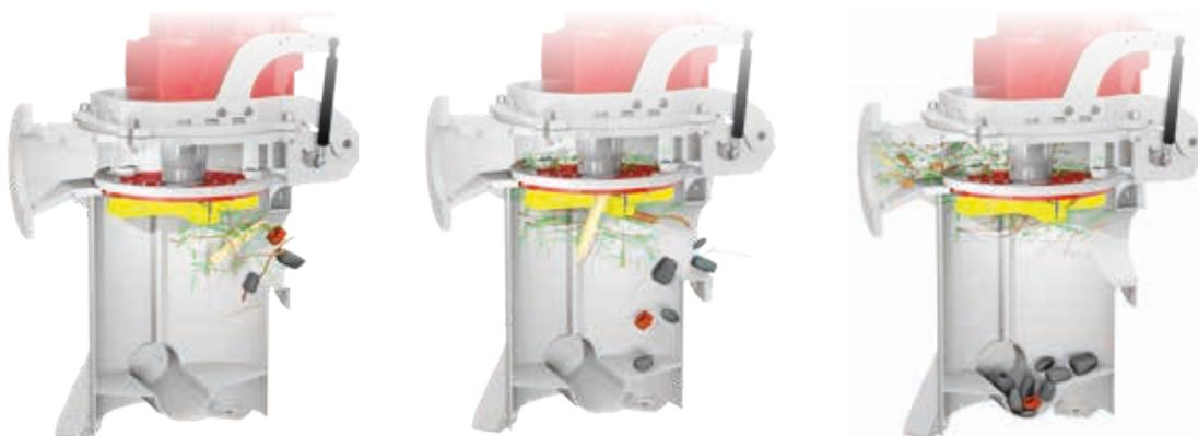
Le liquide pompé s'écoule de façon continue à travers le broyeur RotaCut. Les corps étrangers (pierres, pièces métalliques, etc.) sont séparés en fonction de leur taille ou de leur poids et peuvent être facilement éliminés ultérieurement via une ouverture de nettoyage. Toutes les substances flottantes et en suspension dans le fluide (fibres, poils, os, laines etc.) sont transportées vers l'écran de coupe par le flux de liquide et broyées par les couteaux rotatifs auto-affûtants.
