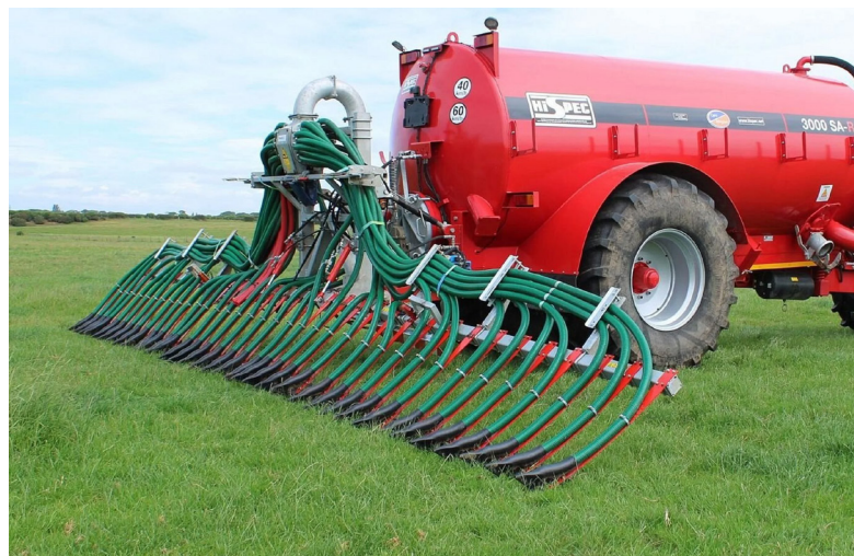
UniSpread van 9 meter: sleepvoetbemester
