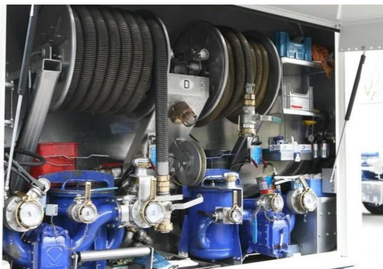
Čerpadla s rotačními písty řady VX od společnosti Vogelsang
