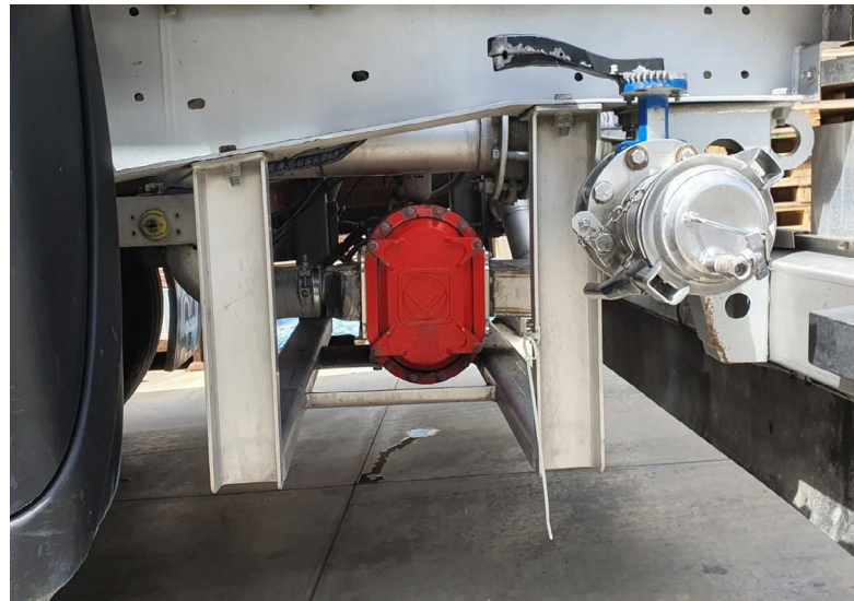
Lobbenpomp VX136-210Q van Vogelsang aangedreven door een dubbele hydraulische motor
