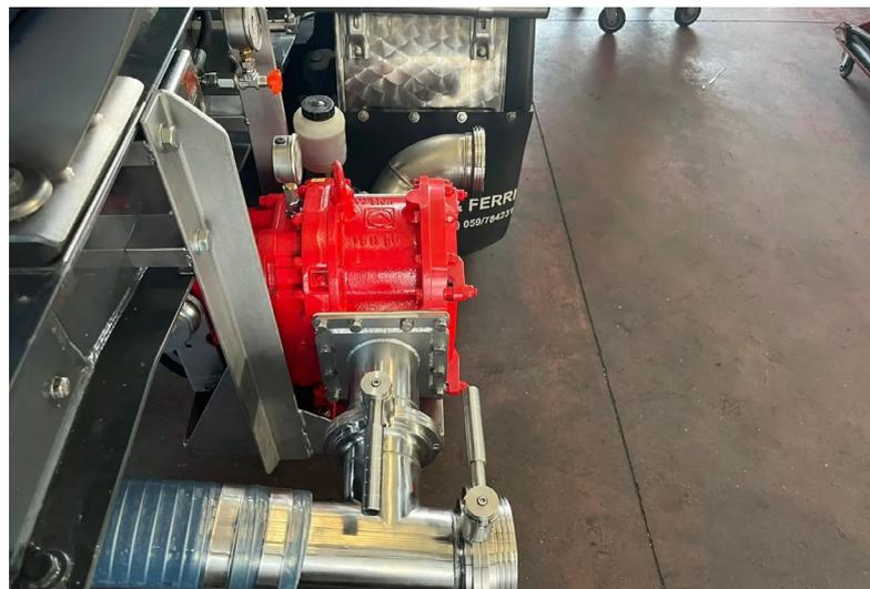
Die Firma SL di Liverani nutzt die Drehkolbenpumpe
