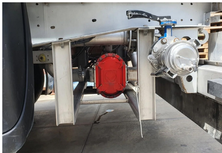
Pompe à lobes Vogelsang VX136-210Q entraînée par un double moteur hydraulique
