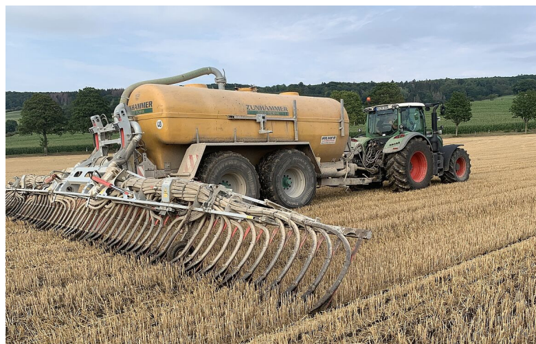
BlackBird slæbeskobom – præcis gylleplacering i smalle striber direkte under afgrøden
