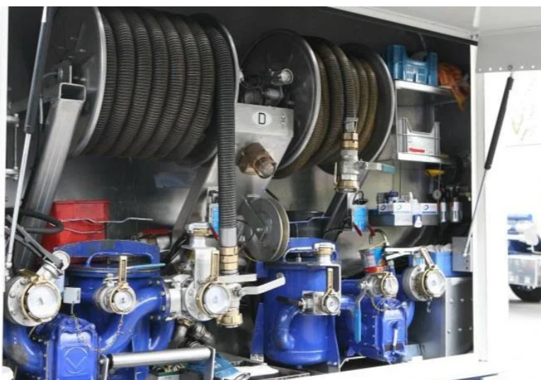
VX rotationspumpe med FPM-lober til genanvendelse af brugte olier
