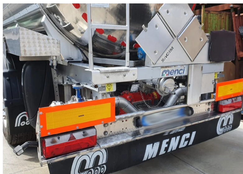
Vogelsang VX rotationspumpe til vakuum og transport af keramisk slam
