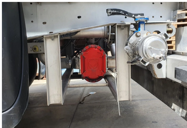
Vogelsang VX136-210Q rotationspumpe monteret på vakuumbekretøj til håndtering af keramisk slam
