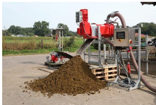
Billede 2: Den nye XSplit separator kan opnå et tørstofindhold på op til 40 procent.
