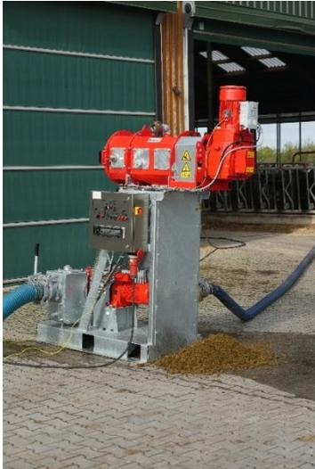
**Bild 3:** Der XSplit Compact: kompakte Systemlösung für die Gülleseparation.
