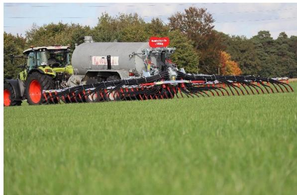
**Bild 2:** Das Schleppschuhgestänge BlackBird Single legt die Gülle emissionsarm und wurzelnah ab.
