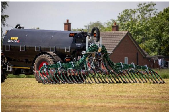
**Bild 1:** Anwender können das Universalgestänge UniSpread wahlweise als Schleppschuh- oder -schlauchgestänge ausrüsten.
