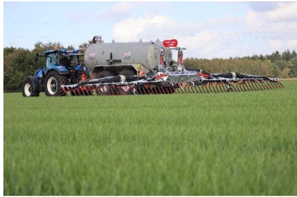
**Bild 6:** Der BlackBird Light ist mit zwei ExaCut ECM-Verteilern ohne Luftnachsaugung ausgestattet.
