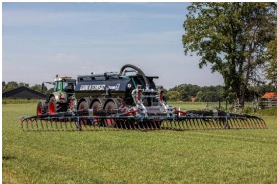
**Bild 7:** Das Schleppschuhgestänge BlackBird Pro, hier in einer Arbeitsbreite von 15 Metern.
