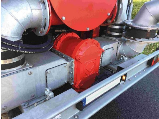
Afbeelding 5: De LoadMaster-pomp wordt gekenmerkt door zijn lage gewicht en compacte inbouwmaten.
