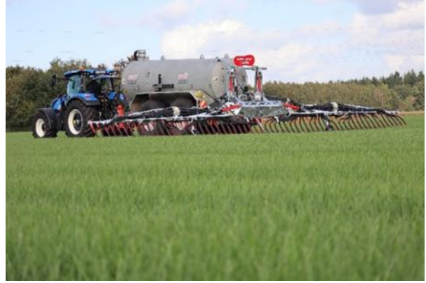
Afbeelding 6: De BlackBird Light is uitgerust met twee ExaCut ECM-precisieverdelers zonder luchtaanzuiging.
