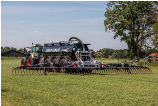
Afbeelding 7: De BlackBird Pro sleepvoetbemester, hier in een werkbreedte van 15 meter.
