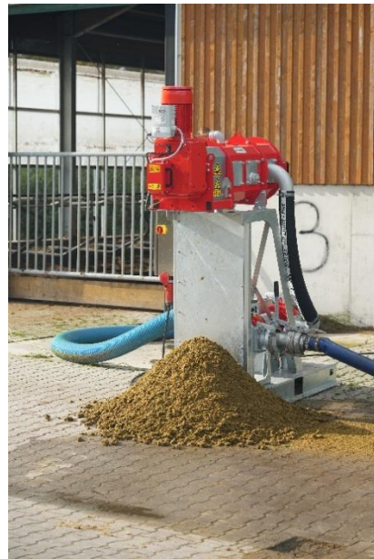
Afbeelding 2: Bij de XSplit Compact met combinatiepomp neemt één enkele pomp de toevoer en afvoer voor zijn rekening.
