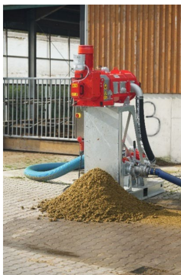
Billede 2: XSplit® Compact – kombinerer separator, pumpe og styring
