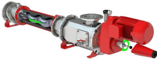
Bild 3: Die konische Rotor-Stator-Geometrie bei der HiCone ermöglicht es, Verschleiß durch einfaches Nachstellen der Förderelemente zu kompensieren.
