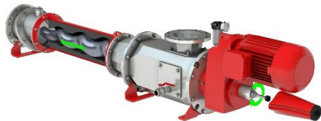
Bild 1: Die konische Rotor-Stator-Geometrie der HiCone ermöglicht es, die Förder Elemente bei Verschleiß formgenau nachzustellen.
