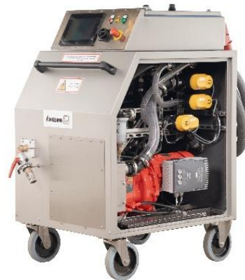
Bild 4: Die BioUnit MID eignet sich für die Reinigung von Bioreaktor-Toiletten.
