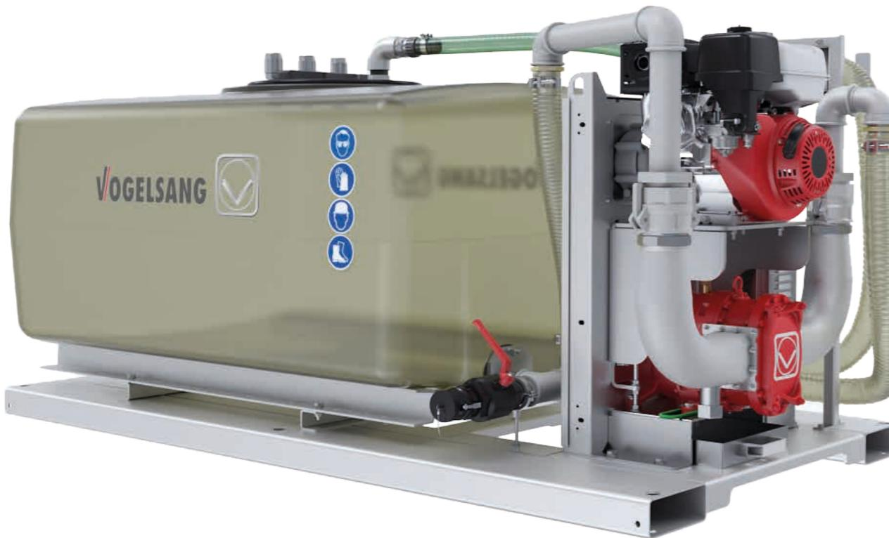
El MobileUnit M Eco WD es un conjunto de eliminación con tanque y unidad de bombeo para varios vehículos de transporte. Este sistema permite el vaciado de depósitos de recogida de aguas residuales sanitarias de trenes de pasajeros, autobuses y embarcaciones.
