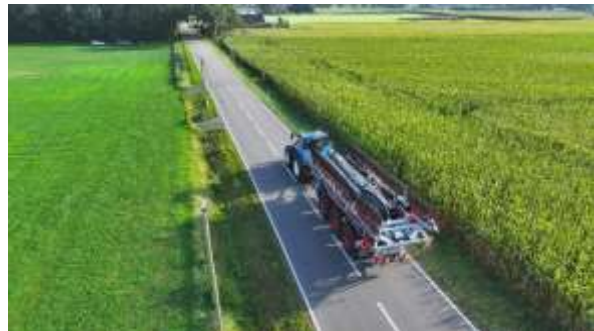
Afbeelding 4: Met een armlengte van 9 meter in transportstand (gemeten vanaf de onderste koppeling) kan de nieuwe grote BlackBird aan een groot aantal mesttanks worden bevestigd.
