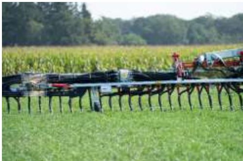
Afbeelding 3: De precisieverdeler ExaCut ECM kan zich zonder luchttoevoer redden en is vier keer geïnstalleerd in de BlackBird van 30 meter.
