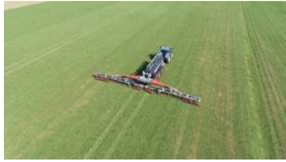
Afbeelding 2: De BlackBird, hier in een werkbreedte van 21 meter. In totaal biedt de flexibele arm werkbreedtes van 30, 27, 24 en 21 meter zonder oversteek buiten de gekozen werkbreedte.
