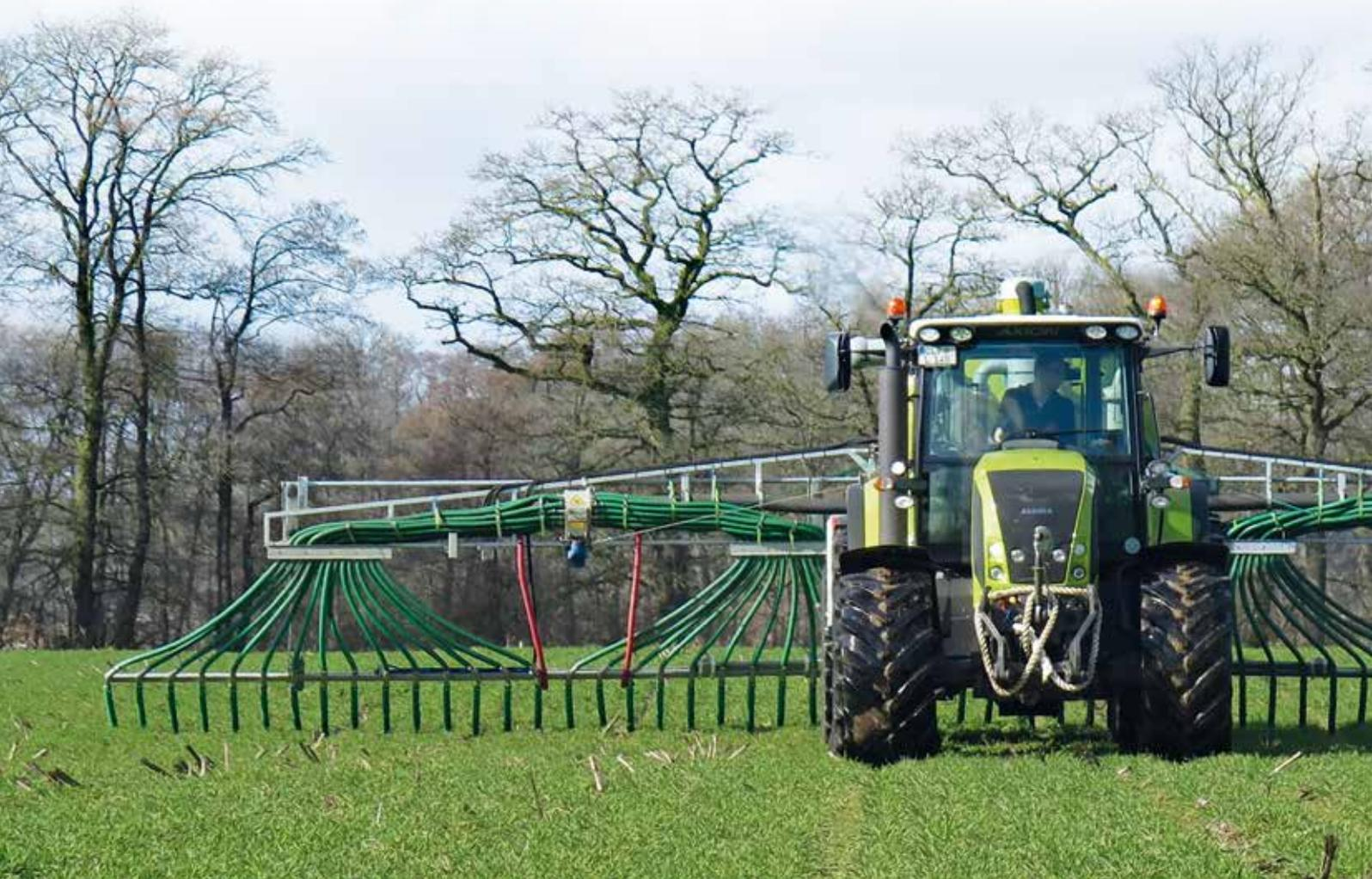
Les SwingUp sont nos rampes petite largeur, assurant une grande stabilité tout en étant flexible dans leur utilisation. Avec par exemple un poids d'environ une tonne seulement pour une largeur de travail de 12 m, la SwingUp 12 est particulièrement légère et convient donc également pour les véhicules compacts.
