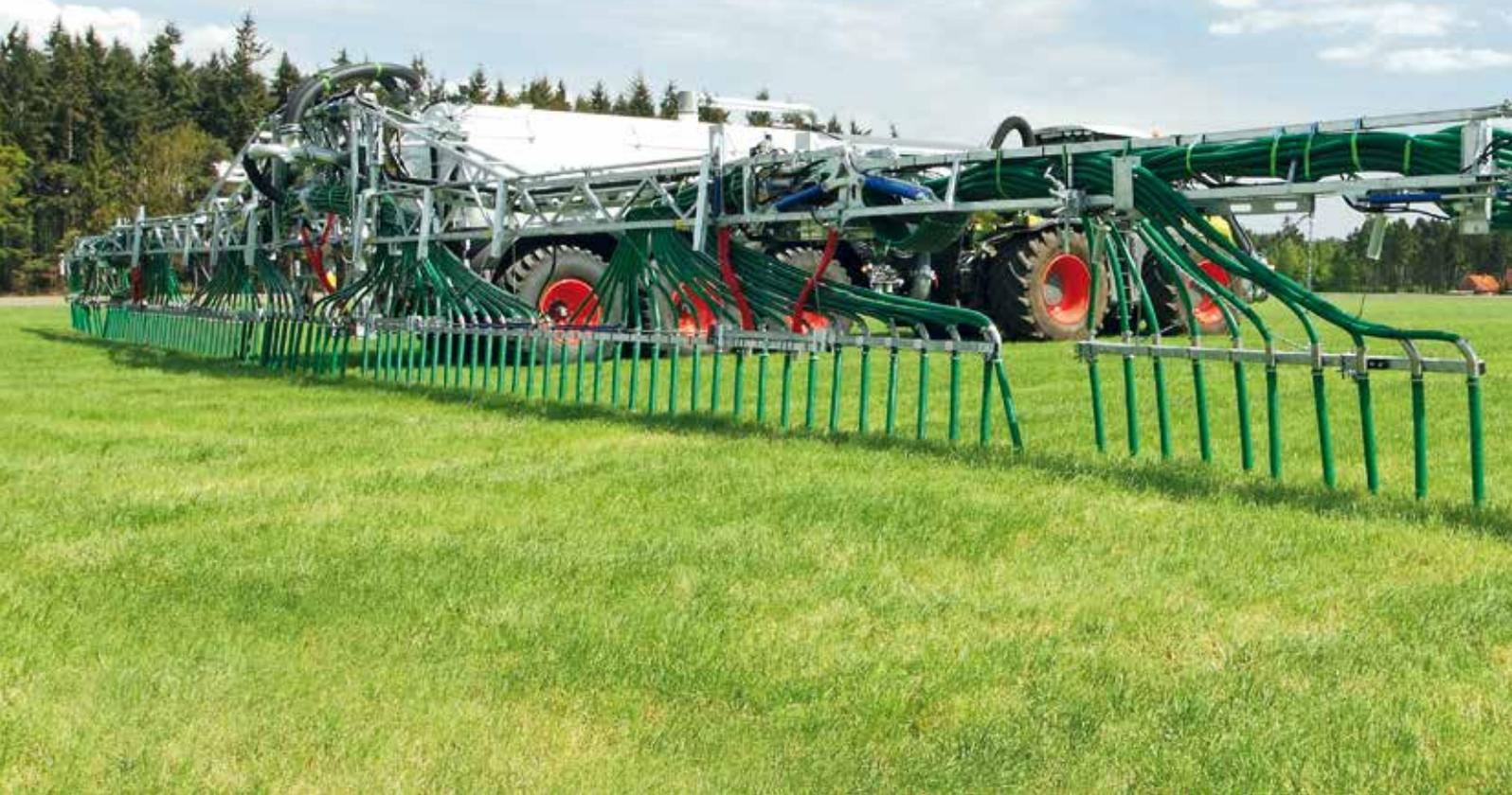
La SwingMax36 entre dans une nouvelle dimension. Pour la première fois, il est possible d'épandre une fertilisation organique sur une largeur de 36m en un seul passage. Cela permet d'utiliser les passages de roues existants, ce qui réduit simultanément le nombre de passages, les temps et coûts d'épandage.
