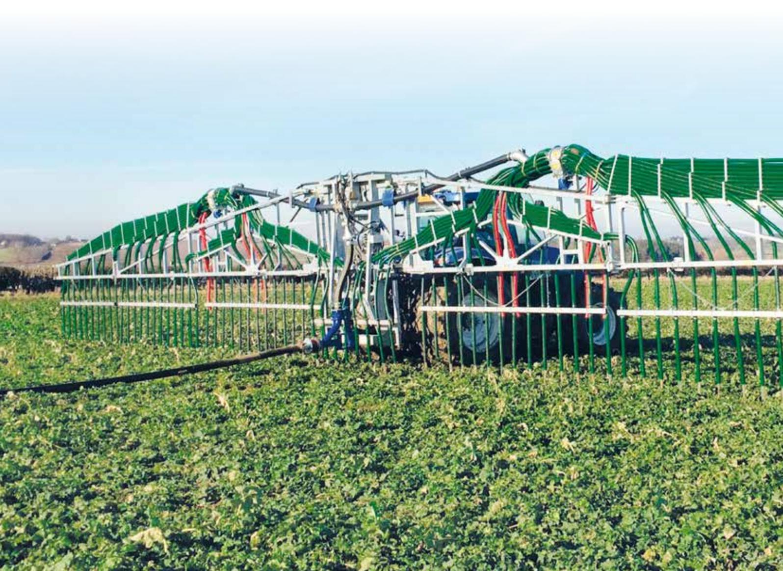
L'épandage d'effluent par système sans tonne permet d'atteindre une nouvelle dimension en proposant une alternative hautement efficace, particulièrement sur les parcelles groupées. Au lieu de transporter l'effluent dans une tonne, celui-ci est directement pompé vers le champ via un système de tuyaux. L'épandage est réalisé sans tonne, directement sur le champ.
