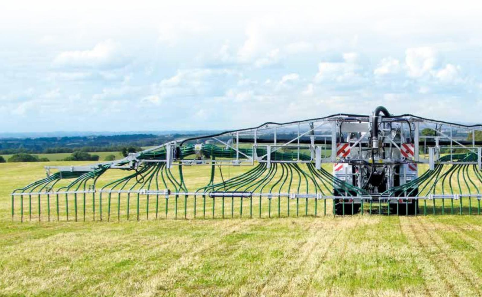
Les SwingMax sont la solution optimale pour l'épandage d'effluent en grandes largeurs de travail. Les équipements tels que TopSwing, DoubleFold, TeleShift et Comfort Flow Control offrent une flexibilité d'utilisation maximale. La construction à double châssis permet une résistance élevée aux contraintes dynamiques, tout en optimisant le poids.
