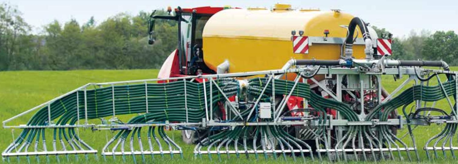
Les pendillards Compax et automoteurs forment une combinaison efficace pour un épandage plus respectueux des sols. Le système de repliage de la Compax a été conçu spécifiquement pour les automoteurs. La Compax se replie complètement derrière le véhicule de manière à ne pas limiter le champ de vision du conducteur, ni élargir le véhicule.
