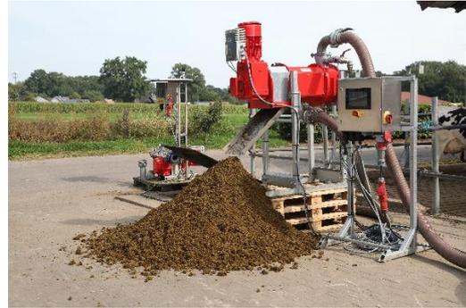
**Bild 2:** Der Pressschneckenseparator von Vogelsang erreicht einen Trockensubstanz-Gehalt im Feststoffanteil von bis zu 40 Prozent.
