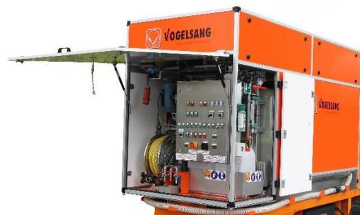
**Bild 4:** Die Reinigungseinrichtung BioUnit ist speziell für die Reinigung von Bioreaktortoiletten konzipiert.
