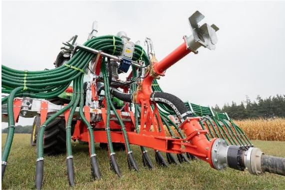
**Bild 1:** Das Universalgestänge UniSpread (hier mit Schleppschuhtechnik) als Verschlauchungsvariante mit Gülle-Zubringerschlauch, Patentwenderohr inklusive Drehgelenk sowie montiertem Streukopf.
