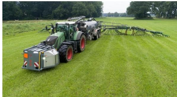
**Bild 4:** Gülleensäuerung bei der Feldausbringung mit SyreN (hier in Kombination mit dem Schleppschlauchgestänge SwingMax).
