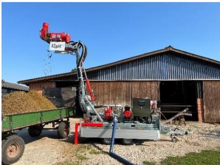
**Bild 3:** Pressschneckenseparator XSplit als Systemlösung mit Pump- und Steuerungstechnik.
