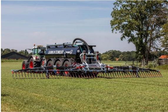
**Bild 1:** Das Schleppschuhgestänge BlackBird, hier in einer Arbeitsbreite von 15 Metern.
