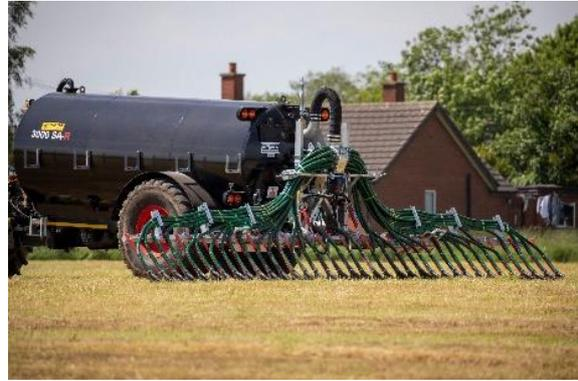
**Bild 2:** Das Universalgestänge UniSpread mit eingebautem Exaktverteiler ExaCut ECQ lässt sich flexibel einsetzen.
