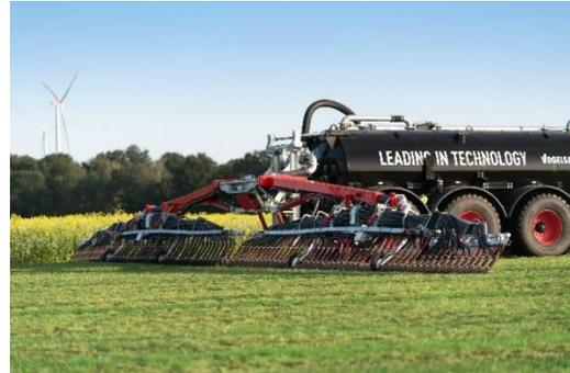
**Bild 2:** Das Schleppschuhgestänge BlackBird zur präzisen, wurzelnahen Gülleapplikation.
