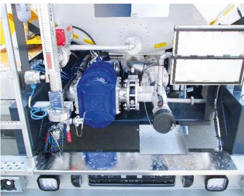
**Bild 7:** Geeignet für enge Platzverhältnisse an Fahrzeugen: Drehkolbenpumpen von Vogelsang
