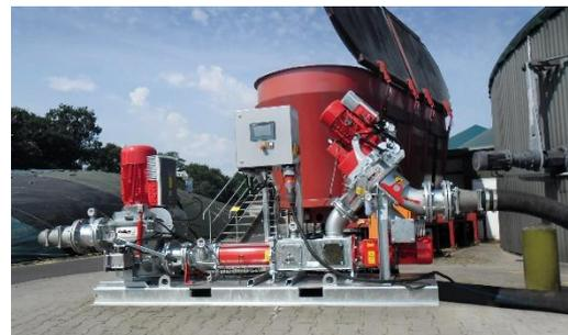
**Bild 4:** Der Vogelsang DisRuptor sorgt für die energieeffiziente mechanische Desintegration in Biogasanlagen.
