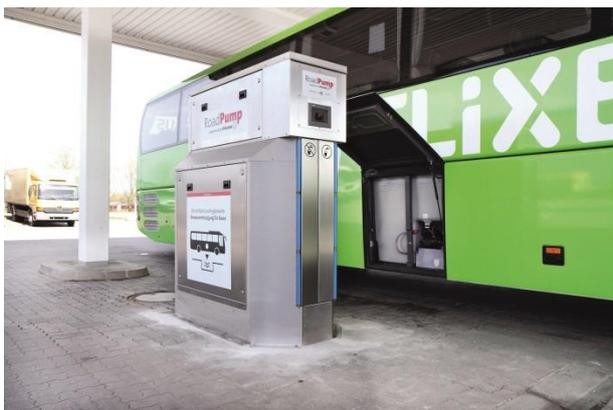
**Bild 3:** Preisgekrönte RoadPump Plus für die hygienische Abwasserentsorgung aus Reisebussen.
