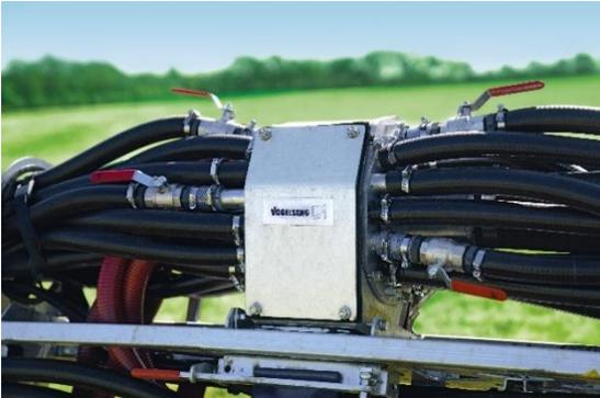
**Bild 3:** Der weiterentwickelte Exaktverteiler ExaCut ECQ ist mittig im Seitenarm positioniert und sorgt für eine gleichmäßige Verteilung der Gülle.
