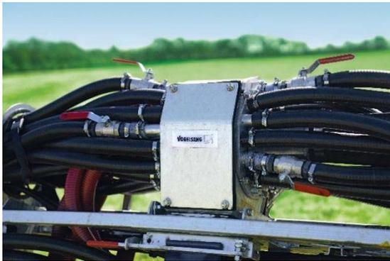
**Immagine 3:** Il distributore di precisione ExaCut ECQ è posizionato al centro del braccio e la manutenzione è rapida perché non richiede la rimozione dello sportello o di altri componenti interni.
