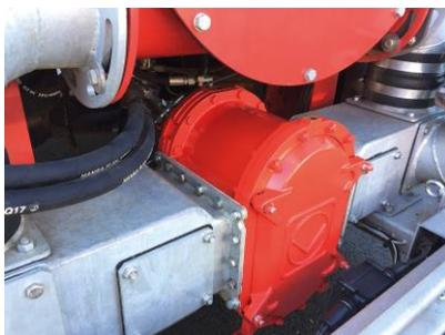
**Foto 5:** La pompa a lobi Rotativi VX186GL, montata su un'autocisterna
